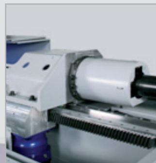
RBV60R Positionnement du tube sur le chariot booster
