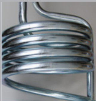
Cintrage de serpentins
