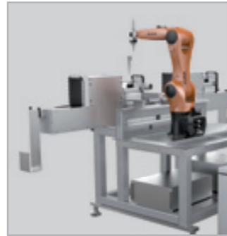
Lichtabgeschirmtes Doppeltunnel-System und Emergency Off
