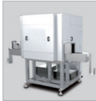
Sicherheitshaube über der kompletten Lasereinheit
